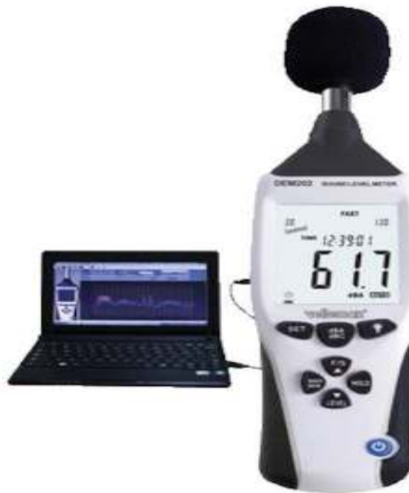
Figur 10: Digital decibelmätare med USB-anslutning
